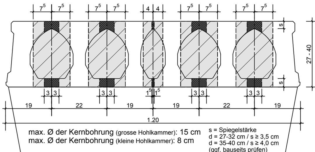
Entwässerungsbohrungen an der Deckenunterseite ca. in Achse Hohlkammer
