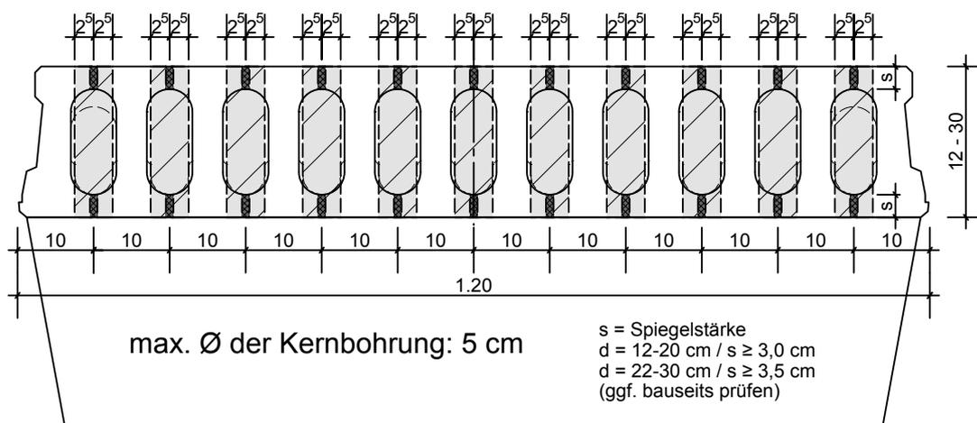
Entwässerungsbohrungen an der Deckenunterseite ca. in Achse Hohlkammer
